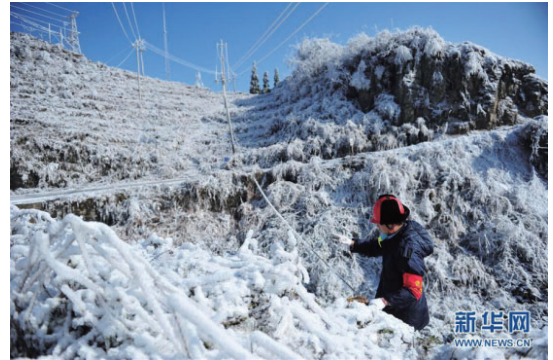
■ 图片来自新华网贵州频道：2018年1月9日，务川供电局工作人员在贵州务川仡佬族苗族自治县石朝乡观测覆冰厚度。
